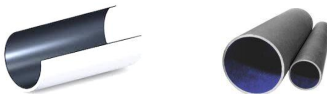
Рис.2 Образцы силикатного покрытия трубопроводов.
