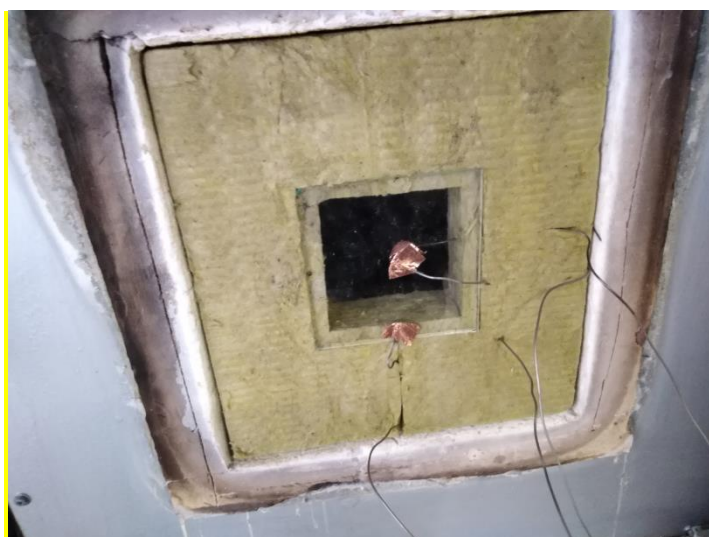
Рисунок 3. Крепление термоэлектрических преобразователей к поверхности стеклянной панели
